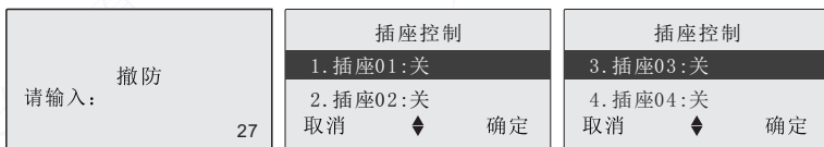
图4：对码操作：按住智能插座开关按钮3秒，直到插座上的电源提示灯开始缓慢闪烁，这时按下[1]键或[3]键来学习智能插座，学习成功时，插座电源指示灯停止闪烁。
