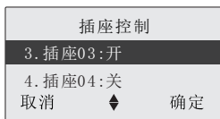
图4：对码操作：按住智能插座开关按钮3秒，直到插座上的电源提示灯开始缓慢闪烁，这时按下[1]键或[3]键来学习智能插座，学习成功时，插座电源指示灯停止闪烁。
